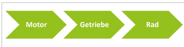
Abbildung 3: Antriebsstrang radnaher Motor
