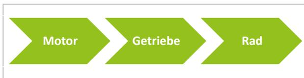
Abbildung 3: Antriebsstrang radnaher Motor
